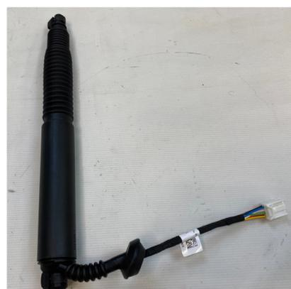
Стойка электропривода для заднего багажника Tesla Model 3 21+ 1551488-99
